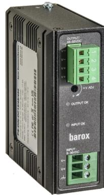
Dieser industrielle Spannungswandler erhöht eine Eingangsspannung von 9-36VDC auf eine für PoE und PoE+ geeignete Spannung von 48-55VDC. Dadurch lassen sich z.B. PoE-Injektoren oder Medienkonverter an Standorten speisen wo nur Spannungen zwischen 9-36VDC verfügbar sind. Der Spannungswandler ist für die Wand- oder die Hutschienen-Montage geeignet. Durch seine kleinen Abmessungen und dem grossen Betriebstemperaturbereich ist er vor allem für den Aussenbereich geeignet.
