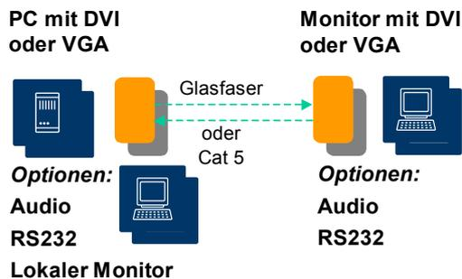
Beim Betrieb von Computertomographen in Krankenhäusern entstehen starke Magnetfelder, welche den Gebrauch eines Monitors verunmöglichen. Durch Verwendung des KVM-Extenders ist auch in dieser Umgebung ein Betrieb mit höchster Bildauflösung möglich.
