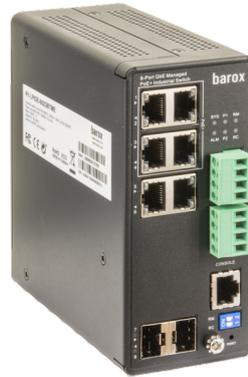
La série comprend des switches robustes et de haute qualité pour la mise en œuvre de puissantes structures de réseau en anneau Ethernet 10, 100 et 1000MBit/s selon la norme IEEE802.x. Les six ports en cuivre disposent tous d'une alimentation par Ethernet avec PoE et PoE+. Ces appareils sont spécialement conçus pour des réseaux vidéo. Le switch permet de construire un ou plusieurs anneaux de fibre optique à tolérance de pannes via deux ou plusieurs ports.
