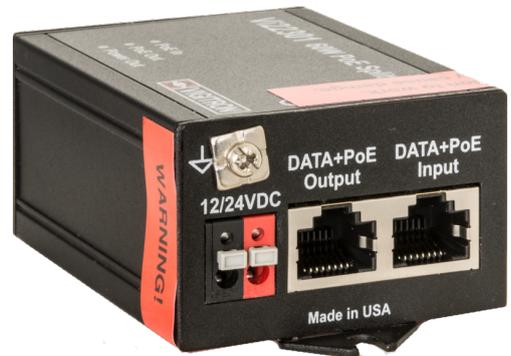
Ce splitter PoE industriel permet une interface de données IP avec PoE+ ainsi qu'une tension continue séparée de 12 ou 24VDC. Par exemple, en plus d'une caméra IP alimentée par PoE, une source de lumière ou un chauffage séparé peut être alimenté. En raison de ses dimensions réduites et de la large plage de température de fonctionnement, l'appareil est particulièrement adapté à une installation en extérieur.
